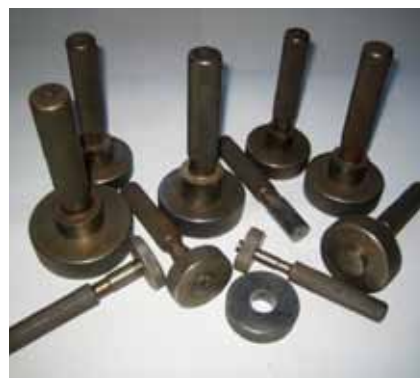
Et eksempel på hvor entusiastiske Jensen og Petersen var: Under opholdet i Tyskland 1896-99 fremstillede de i deres fritid dette sæt prøvedorne i størrelser fra 3/8 til 1 1/2 tomme. De har højt sandsynligt været anvendt da de fremstillede bilen. Dornene er stadig i familiens eje, men de har vist ikke været brugt siden mellemkrigsårene.
