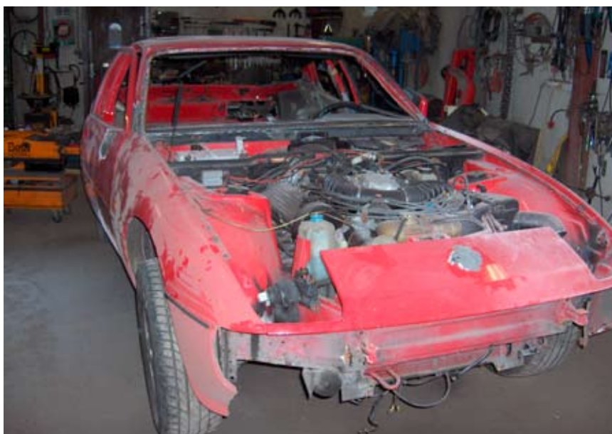
På vinterbesøg hos vores dygtige mekaniker Jørgen i Nørreby på Nordfyn, hvor han som "indimellembil" kigger den efter i sømmene, og desværre mest i svejsesømmene. Billedet viser ganske godt hvor meget "hjertet" fylder i et motorrum, der i øvrigt stadig har sin originale lak (tomatfarvet). Man ser på billedet slangerne til den mekaniske benzinindsprøjtning. Også strømfordeleren er mekanisk. At indsprøjtningen kan fordele benzinen til fire cylindre med motoromdrejninger på 8.000/minut er for mig ubegribeligt. Det var Porschen desværre pludselig enig med mig i på en ferietur midt på motorvejen ved Frankfurt. En ny benzinpumpe løste problemet.
