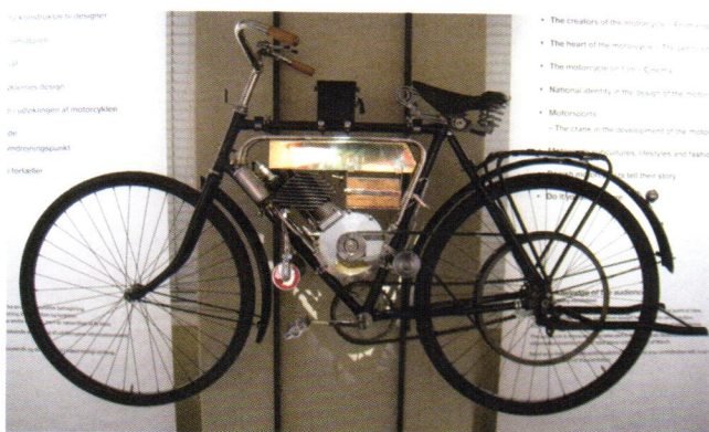
Motosacoche, dvs. motoren i tasken, 250 ccm, 1906. Schweiz. Rendyrket fornuftsbetonet konstruktionsæstetik, 1 motor + 1 cykel = 1 motorcykel. Man tager 'motoren i tasken' spænder motoren på cykelstellet og påsætter drivrem. Enklere kan det ikke gøres. Solgtes herhjemme også under navnet E.L.G. Findes på Danmarks Tekniske Museum.
